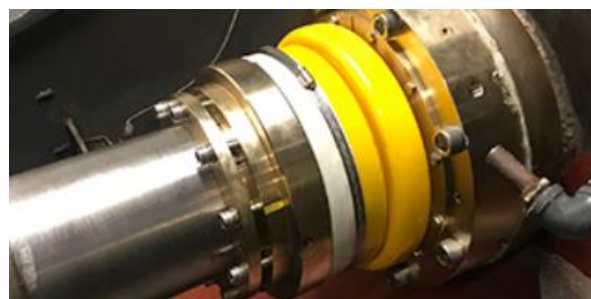
Rys. 8 Uszczelnienie czołowe TG100 firmy Thordon.
