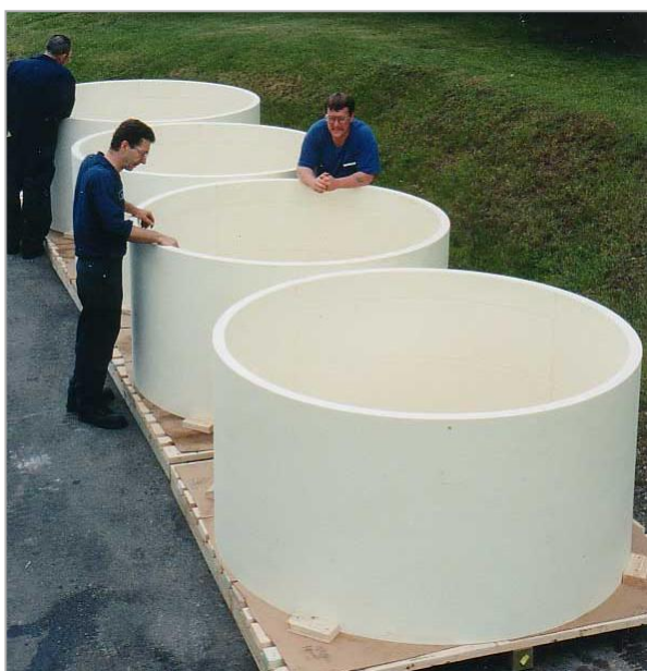
Rys.3 Tuleje łożyskowe z materiału Thordon SXL.
