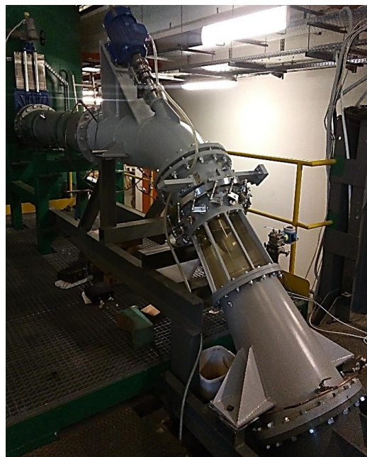
Rys.1 Niskospadowa rurowa turbina Kaplana o wysokim wyróżniku szybkobieżności zamontowana na stanowisku do badań turbin wodnych w IMP PAN.
