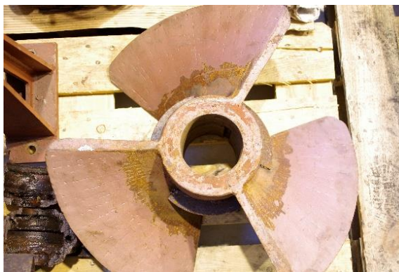
Rys.2 Oryginalny wirnik turbiny śmigłowej po demontażu istniejących maszyn
