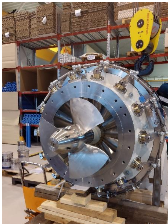
Rys.5 Montaż nowej turbiny Kaplana UHE500 w siedzibie właściciela elektrowni (Redzikowo niedaleko Słupska)
