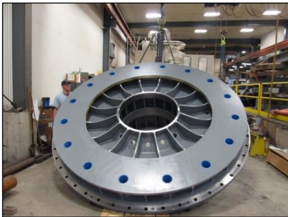
Rys. 6 Łożyska czopów aparatu kierowniczego z Thordon ThorPlas Blue, zainstalowane w gniazdach pierścienia łopatkowego.
