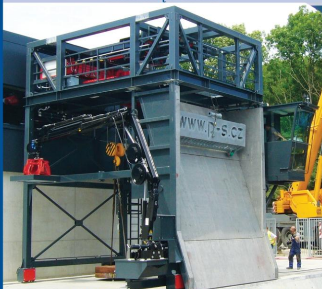
EW Šteti n/ Ľabą 2014 spad H=15,2 m, udźwig zgarniacza Q= 1500 kg
